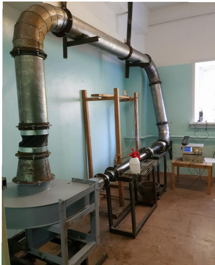
Рисунок 34 - Общий вид стенда для лабораторных испытаний поточных датчиков для измерения электрического сопротивления жидкости
